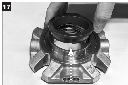
17 Wyjąć wewnętrzny stacjonarny pierścień uszczelniający z dławika i wyrzucić.
